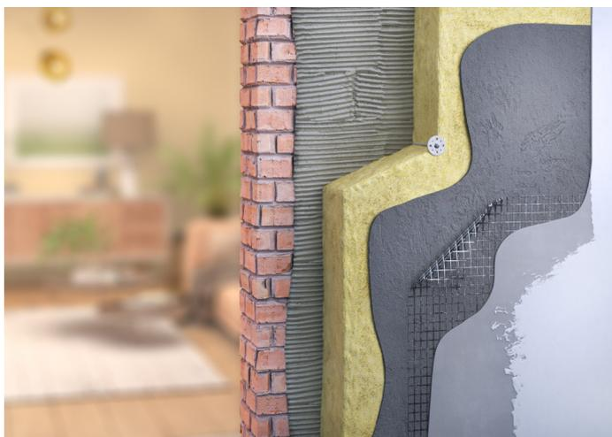
Rivestimento esterno di facciate nuove o in ristrutturazione per ottimizzare la prestazione termica dell'edificio.
